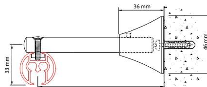
Wandmontage mit kürzbarem Wandwinkel 4217-101, der Winkel kann bis zu  $x = 50$  mm gekürzt werden.
