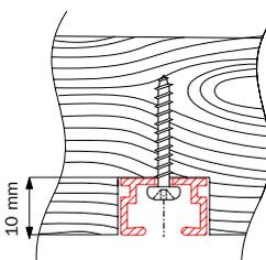
Montage der 4701 mit Deckenträger 4750 und einer Standardholzschraube
