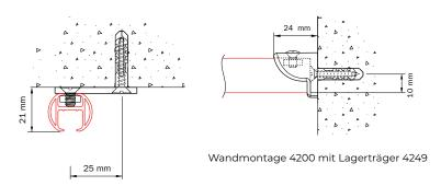
Wandmontage mit kürzbarem Wandwinkel 4217-101, der Wandwinkel kann auf x = 50 mm gekürzt werden
