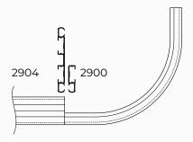
Kombination des breiten Profils 2904 mit 90-Grad-Rücklauf 2900-R-W, verbunden über den Schienenverbinder 2952.
