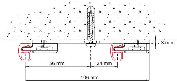
Wandmontage mit Metallwandwinkeln und Deckenträgern 2150.
